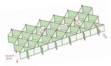
La solution M3S® est composée d'un ensemble de bandes de géotextile cousues qui constitue une nappe alvéolaire tridimensionnelle. Afin de valoriser les ressources naturelles, cette nappe alvéolaire s'utilise en association avec un matériau de remplissage qui peut être n'importe quel sol ou granulat compactable. La fonction de renforcement est garantie grâce à la superposition des nappes alvéolaires remblayées et compactées
