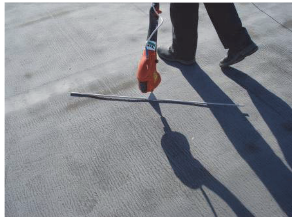
Figure 11. Contrôle de la géomembrane par la méthode du balai électrique
