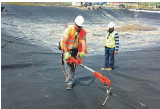
Figure 2. Identification d'un défaut dans la géomembrane et marquage.
